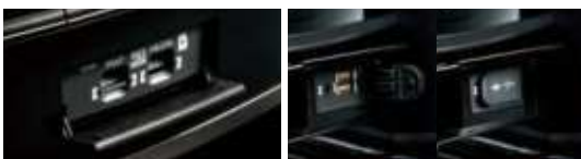
microSDカードスロット部 ※写真はオープン時。 USB(2個)/AUX(音声・映像*12)入力端子
