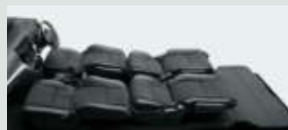
フロントシート・セカンドシートフラットモード (サードシート床下格納)
