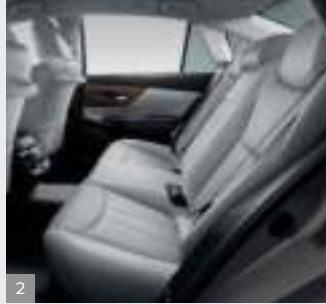
2 左右席はシートリクライニングが無段階調整可能。 リヤパワーシート(40/20/40分割リクライニング)
