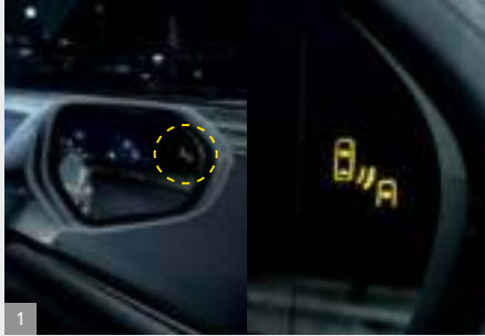
1 死角エリアに入った車両の存在をお知らせ。 ブラインドスポットモニター[BSM]/ 後方車両への接近警報
