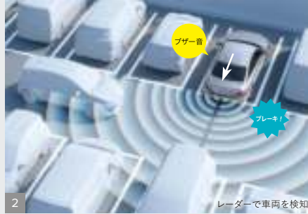
2 後退時、接近してくる車両に対して自動(被害軽減)ブレーキが作動。 リヤクロストラフィックオートブレーキ [パーキングサポートブレーキ(後方接近車両)]/ リヤクロストラフィックアラート
