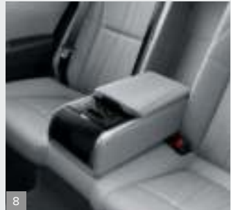
8 空調などもコントロール可能。収納スペースとして活用することも。 リヤセンターアームレスト(カップホルダー+ボックス&各種コントロールスイッチ付)
