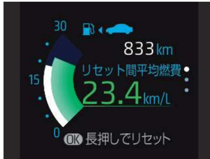
マルチインフォメーションディスプレイ表示例 （エコ燃費）
