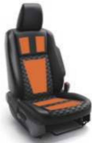
オレンジは、ヒーター加温箇所
