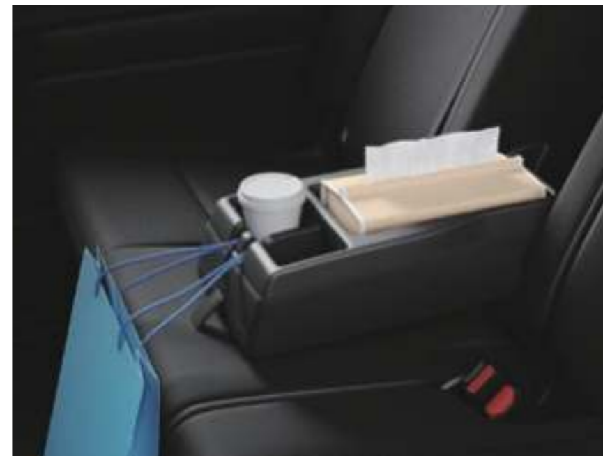
⑫格納式センターボックス（カップホルダー2個＋オープンボックス＋エコバッグフック付） [8人乗りに標準装備*1]
