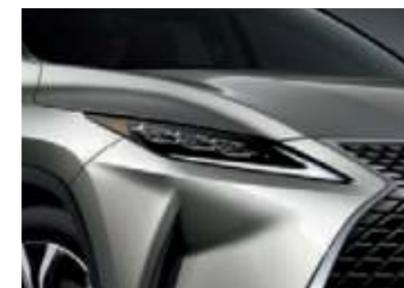
ハイビームの遮光エリアをより細かく制御できる、このブレードスキャン®方式は、高速回転するブレードミラーにLEDの光を反射させ、その残像効果によって前方を照らすユニークな構造。ブレードミラーの回転に合わせてLEDの点灯・消灯を制御することで、遮光エリアを狭めることを可能にし、照射範囲の拡大を実現しています。これにより対向車や先行車を眩惑することなく、遠方の歩行者や標識、路肩などを、より早く鮮明に照らし出すことに成功しました。しかし、新しいテクノロジーであるが故に、実用化までの道のりは長く険しいものでした。まず、LEDの光を照射する反射鏡をいかにコンパクトに仕上げるか。扇風機型のブレードミラーというかたちに辿り着くまで、試行錯誤を繰り返したのです。次に、高速回転するブレードミラーの耐久性の確保はもちろん、あらゆるシーンにおいて
