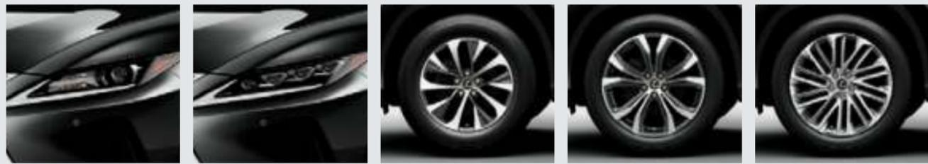
LEDヘッドランプ(ロー・ハイビーム) 三眼フルLEDヘッドランプ(ロー・ハイビーム)&LEDシーケンシャルターンシグナルランプ(フロント・リヤ) 235/65R18タイヤ&アルミホイール(切削光輝) 235/55R20タイヤ&アルミホイール(切削光輝) 235/55R20タイヤ&アルミホイール(ハイパークロームメタリック塗装)
