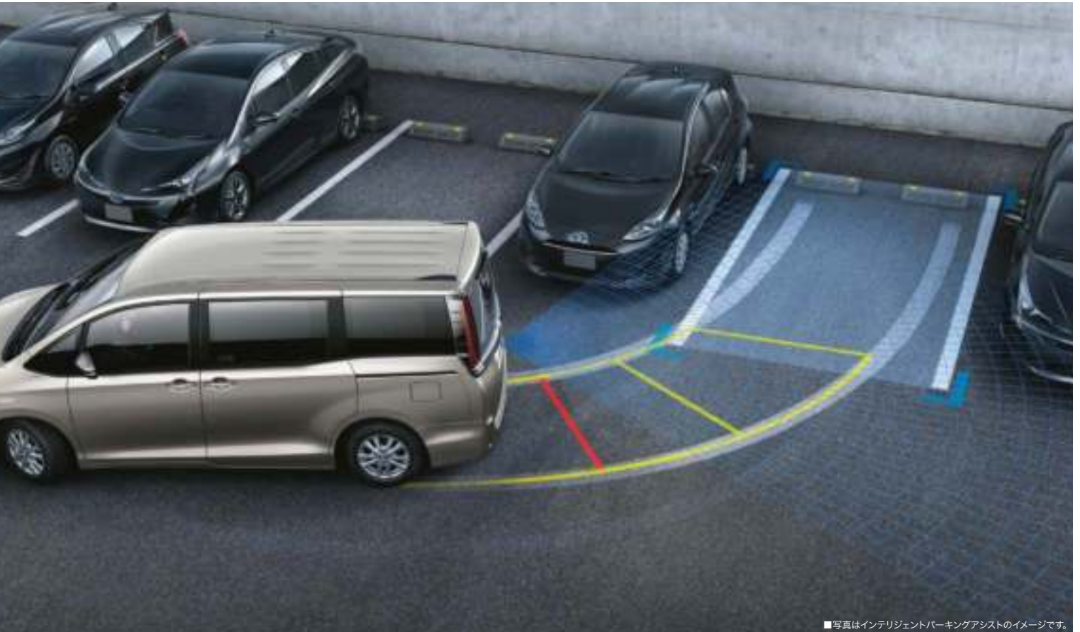
■写真はインテリジェントパーキングアシストのイメージです。
