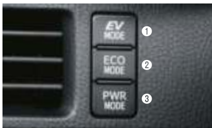
■設定した各モードスイッチをもう一度押せば、「通常走行モード」に戻ります。 ■スイッチはセンタークラスター部に設定。
