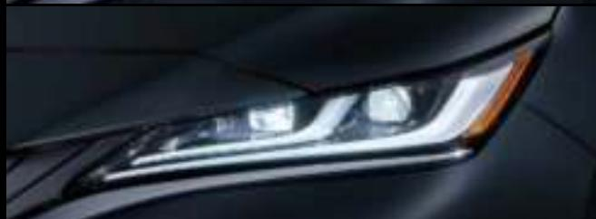
▶プロジェクター式LEDヘッドライト（オートレベリング機能付）+LEDデイタイムランニングランプ+LEDクリアランスランプ+LEDターンランプ
