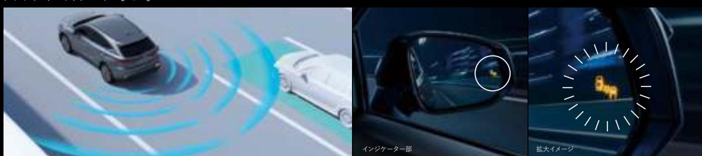
隣の車線を走る車両をレーダーで検知。ドアミラーでは確認しにくい、後側方エリアに存在する車両に加えて、隣接する車線の最大約60m後方までモニターし、急接近してくる車両も検知します。車両を検知すると、ドアミラーに搭載されたLEDインジケーターが点灯。その際、ウインカーを操作するとLEDインジケーターが点滅し、より注意を喚起します。
