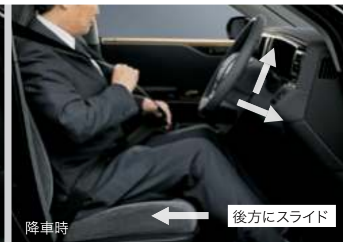
プリセットドライビングポジションシステム(シート[運転席・助手席]・ステアリング・ドアミラー)
