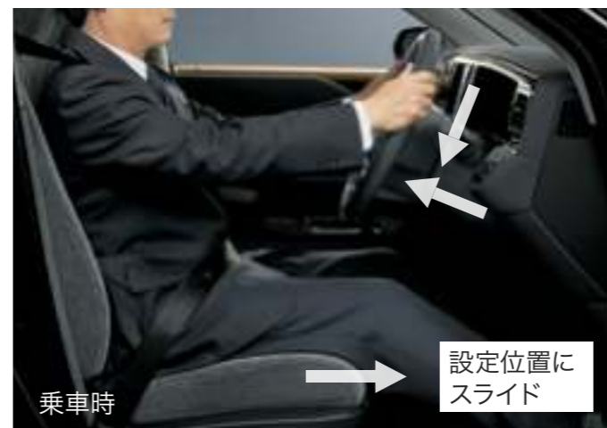
プリセットドライビングポジションシステム(シート[運転席・助手席]・ステアリング・ドアミラー)
